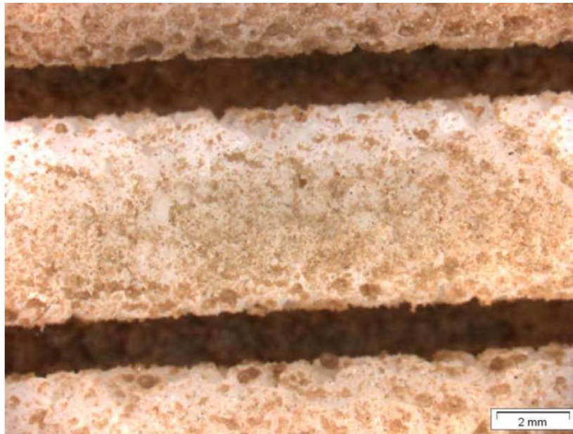
Abbildung 8 Detailaufnahme der Partikelablagerungen an den Filterstäben auf der Rohluft-Anströmseite nach Bestäubung mit ISO-fein (ISO 5011).
